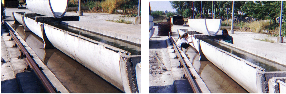
EK L 2,3. Test sahas,na getirilen kanaletlere boyuna yükleme testi yap,lm, t,r.
