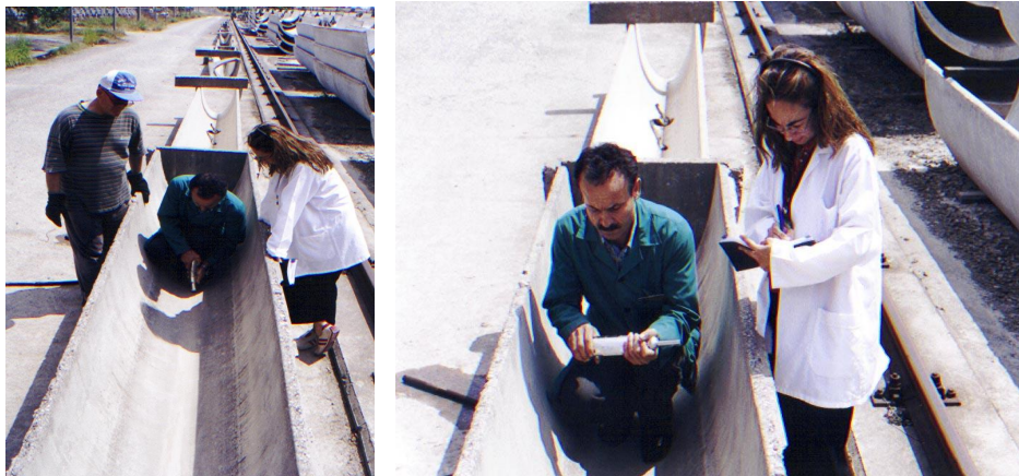
EK L 6, 7. Kanalet basınç dayanımlarının tespitinde beton test çekici de kullanılmıştır.
