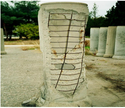
Resim 5,6. Kafes donatısının burulmasından kaynaklanan üretim fireleri.
