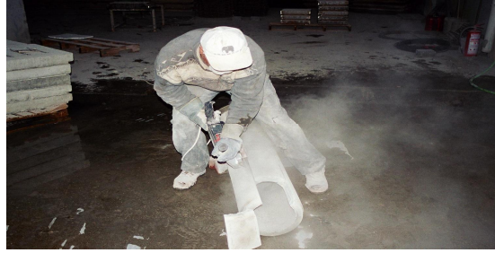
Resim 9. Çelik lifli borudan numune alınması.
