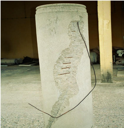
Resim 7,8. Kafes donatısındaki kaynağın kopmasından kaynaklanan üretim fireleri.
