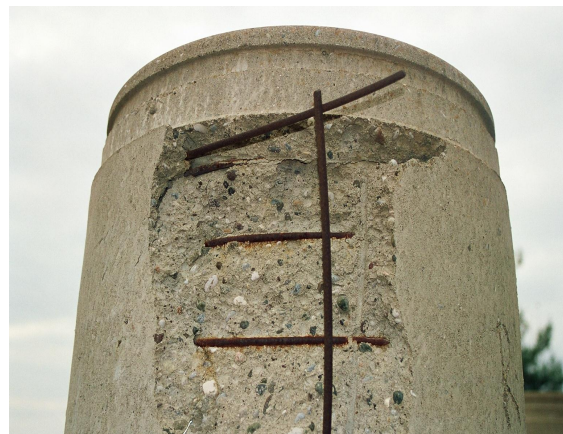
Resim 7,8. Kafes donatısındaki kaynağın kopmasından kaynaklanan üretim fireleri.
