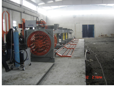
Foto raf 9. Fore kaz,k donat,s, haz,rlama makinesi.
