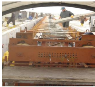
Şekil 1 ve 2. Öngermeli prekast kiriş üretimi
