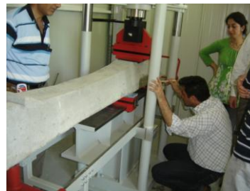
Şekil 5. Traverste statik test yapılması
