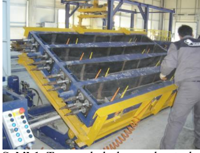
Şekil 1. Travers kalıplarının kontrolü
